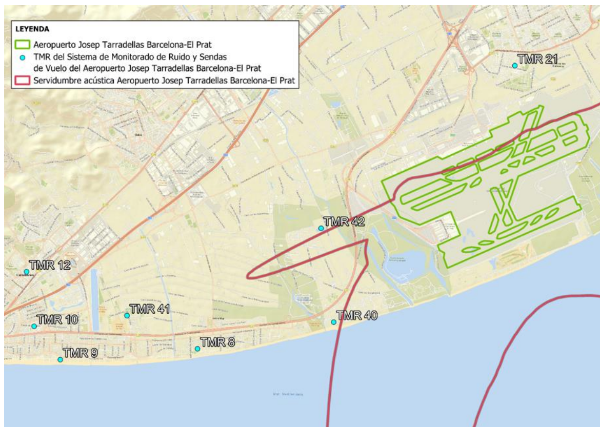
Figura 1. Localización de los Terminales de Monitorización de Ruido (TMR) en el entorno del Aeropuerto de Josep Tarradellas Barcelona-El Prat. Fuente: elaboración propia
